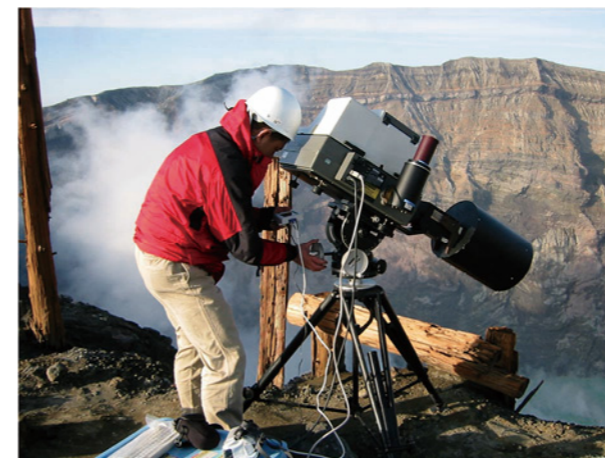
阿蘇中岳第一火口での赤外分光放射計を用いた火山ガス化学組成の遠隔測定の様子
