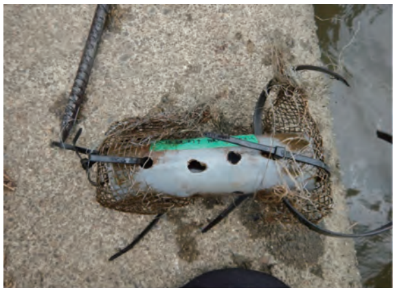
回収したロガー。破損を防ぐため手作りで防護した。
