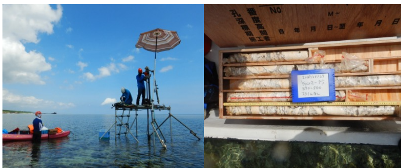
図1 西表島のサンゴ礁の掘削 (左) と得られたコア (右)。
