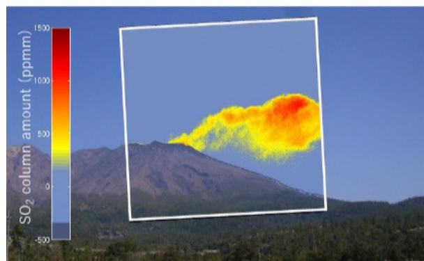
(上) 桜島の写真 (下) 桜島の写真に可視化した火山噴煙の二酸化硫黄カラム量分布を合成した図。森 (2018) より。
