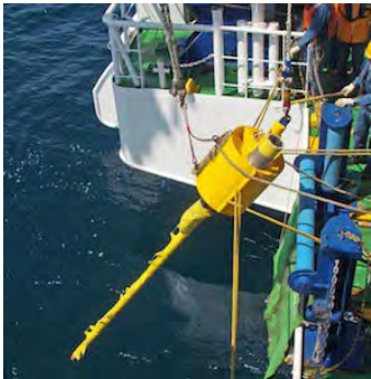
海域での熱流量測定（この装置を海底に突き刺す）
